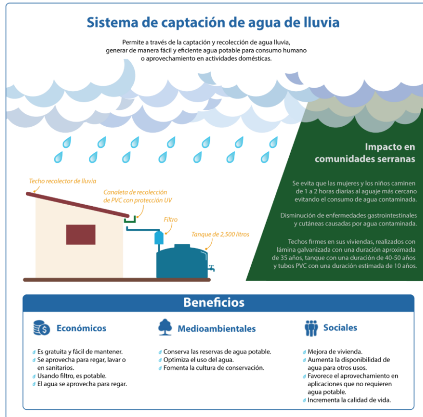
Diagrama 4 Sistema de Captación de Agua Lluvias y sus Partes
