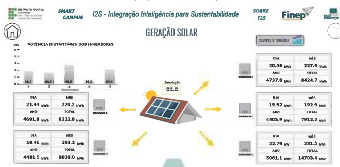
Figura IX.3 Módulo de controle de geração e consumo de energia fotovoltaica do I2S
