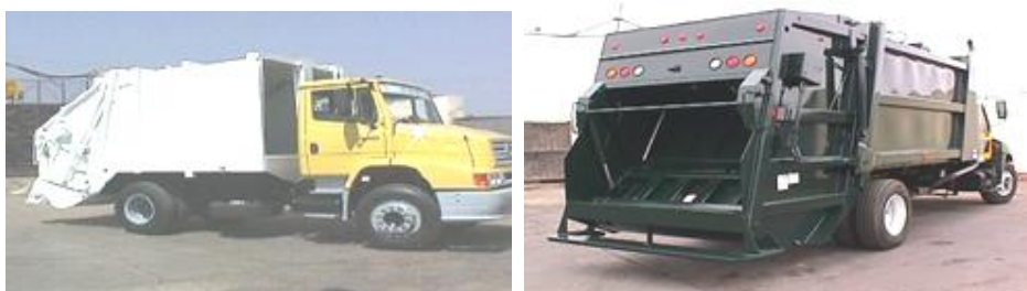
Imagen 2 Recolector compactador de carga trasera 15 y 19m 3
