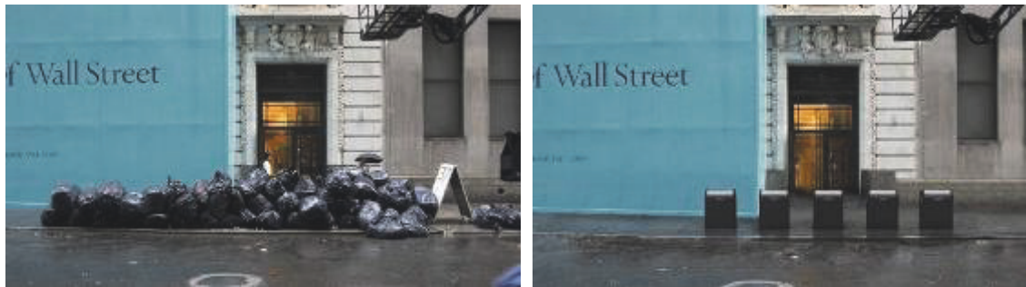
Imagen A.13 Contenedores soterrados (foto montaje)
