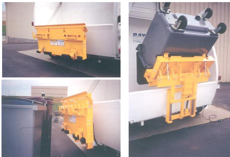
Imagen 3 Camión recolector de contenedores, carga trasera
