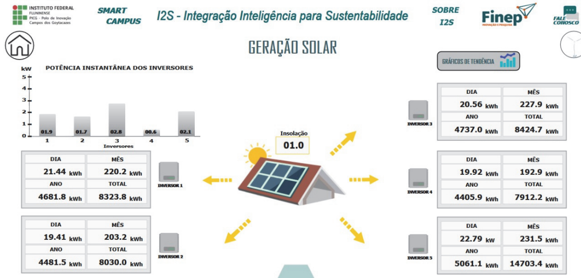
Figura IX.3 Módulo de controle de geração e consumo de energia fotovoltaica do I2S
