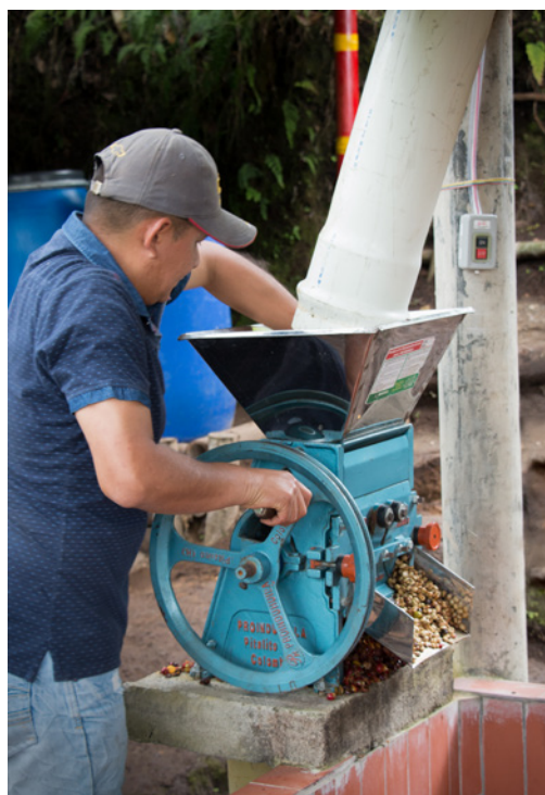
Miembro realiza calibración de máquina despulpadora de café. Foto: Cosurca.
